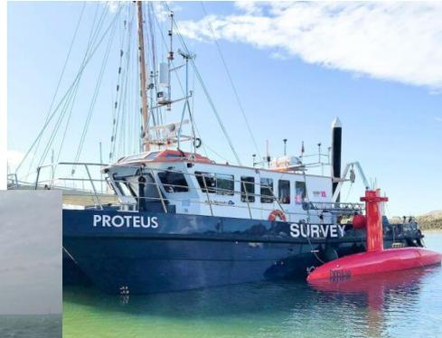
Erfolgreicher Test von "DRIX", ein 8 m „Autonomous Unmanned Survey Vessel“ (AUSV) von iXblue (2018)
