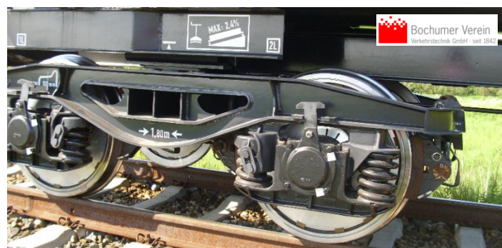
Abbildung 18: Radkappenschallabsorber des Bochumer Vereins am Güterwagen [FEH11]
