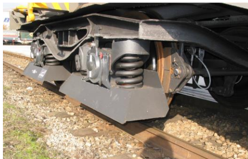
Abbildung 22: Beispiel von Radsatzschürzen für Güterwagen aus dem Projekt Low Noise Train seitens ÖBB und SBB [HEWI02]
