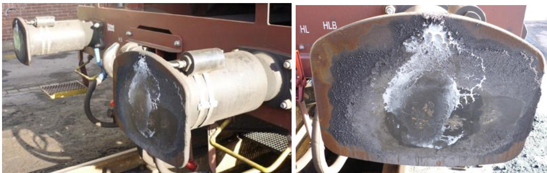
Abbildung 30: Das automatische Pufferschmiersystem von „Faiveley“ im Einbauzustand in Seitenansicht (links), Frontansicht des geschmierten Seitenpuffers (rechts) [SCV13]
