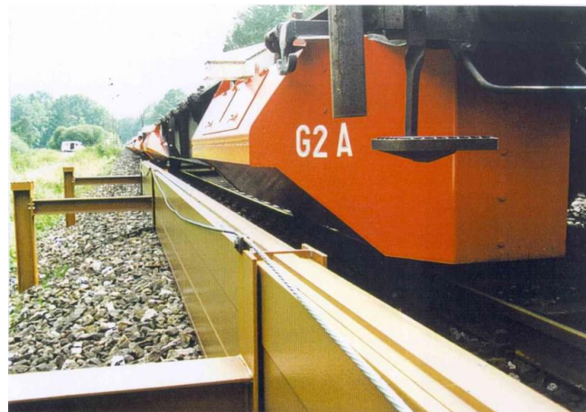
Abbildung 20: Test einer Lärmschürze bei der DB befestigt am Wagenkasten mit einer niedrigen Schallschutzwand [TU Berlin]
