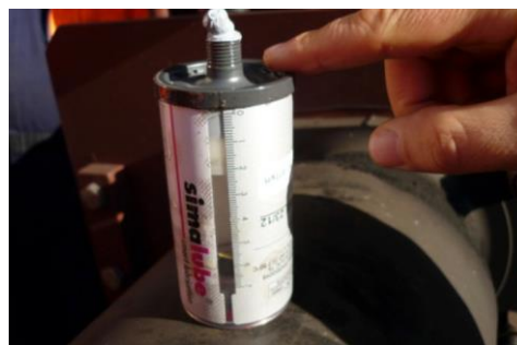
Abbildung 33: Schmierkartusche für eine automatische Pufferschmierung im ausgebauten Zustand [SCV13]
