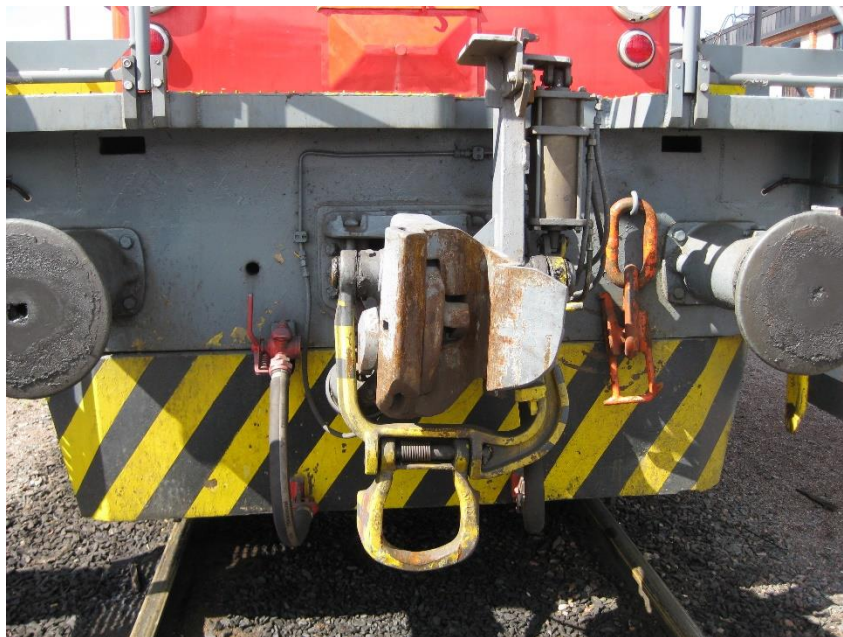
Abbildung 27: Vapitikupplung an finnischer Rangierlok mit Willisonkupplung und Seitenpuffer, bereit für Kupplung mit SA-3-Kupplungen ausgestatteten Wagen, Aufnahme 2010 [TU Berlin]
