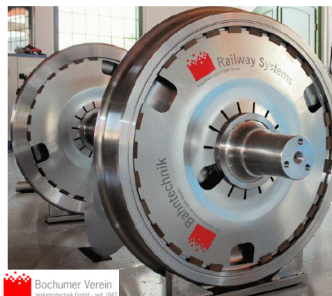
Abbildung 17: Radkappenschallabsorber des Bochumer Vereins, vorletzte Entwicklungsstufe [FEH11]
