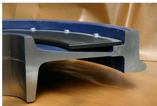
Abbildung 16: Axial-Radschallabsorber von GHH-Bonatrans am Schienenrad [GHH16]
