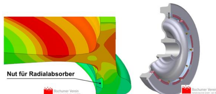
Abbildung 13: Radial-Radschallabsorber des Bochumer Vereins am Schienenrad mit Nut zur Befestigung [FEH11]
