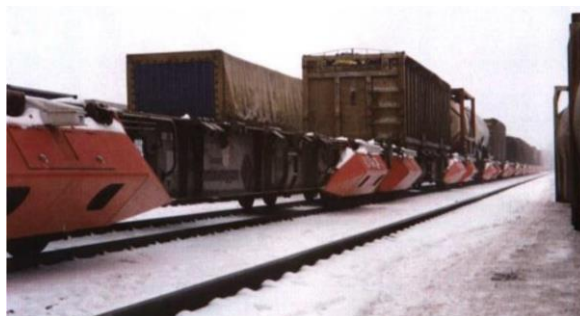
Abbildung 21: Lärmschürzen am Low Noise Train mit seitlichen Öffnungen zur Einsehbarkeit im Wintertest [MAH15]
