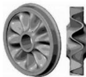
Abbildung 2: Wellenstegrad in verschiedenen Ansichten [KLO12]
