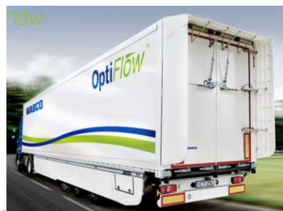
Abbildung 24: Aerodynamische Optimierung eines Lkws durch Leitbleche und Seitenverkleidungen [WAB16]
