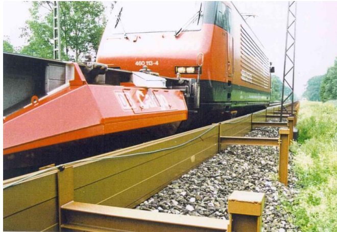
Abbildung 19: Test einer Lärmschürze mit Befestigung am Wagenkasten in der akustischen effektivsten Kombination mit einer niedrigen Schallschutzwand und leiser, präparierter SBB-Lok BR 460 [TU Berlin]
