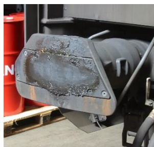
Abbildung 29: Exemplarische Gleitplatten integriert in die Pufferfläche [TU Berlin]
