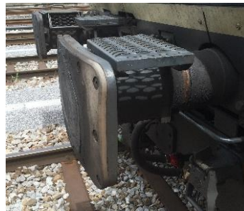
Abbildung 28: Exemplarische Gleitplatte über die gesamte Stirnfläche von Seitenpuffern einer Lokomotive [TU Berlin]
