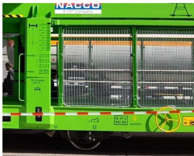
Abbildung 26: Moderner Autotransportwagen von Waggonbau Niesky mit seitlichen Gitter zum Schutz vor Vandalismus aufgenommen auf der Innotrans 2016
