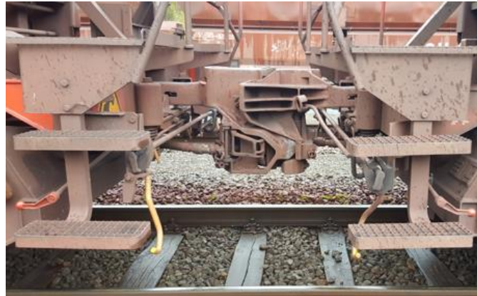
Abbildung 36: Bedieneinrichtungen gemäß UIC MB 535-2 inkl. Stellungen (links), gekuppelte „AK69“ mit deutlich erkennbarer Bedieneinrichtung in Gelb in der Grundstellung sowie separat vorhandenen Luftabsperrhähnen mit rotem Griff (rechts)
