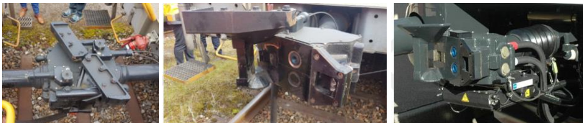
Abbildung 22: Schwab-Kupplungen: SGV Ausführung im „5L“-Demonstrator aus 2018 in Muttenz im gekuppelten (links) und entkuppelten Zustand (Mitte), sowie in der Vollbahnausführung (rechts)
