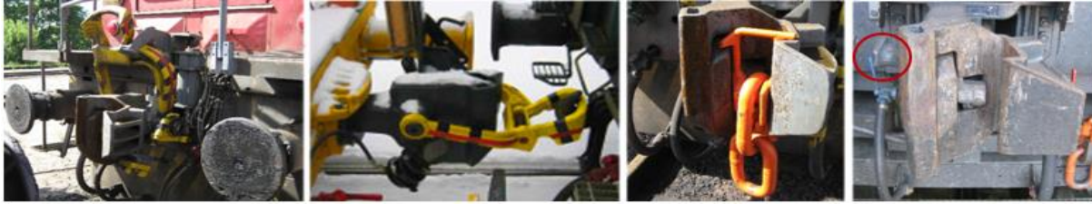
Abbildung 6: Von links nach rechts: SA3-Kupplung mit Rangieradapter für SK hochgeklappt und im Eingriff im Zughaken der SK, „SA3“ mit eingehängten SK-Adapter und „SA3“ mit zusätzlichem Horn (rot eingekreist) auf der linken Seite zum Einhängen der SK als Zughakenersatz
