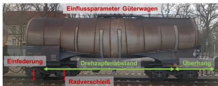
Abbildung 37: Übersicht über die Einflussparameter auf den Greifbereich von AK am Beispiel eines Güterwagens
