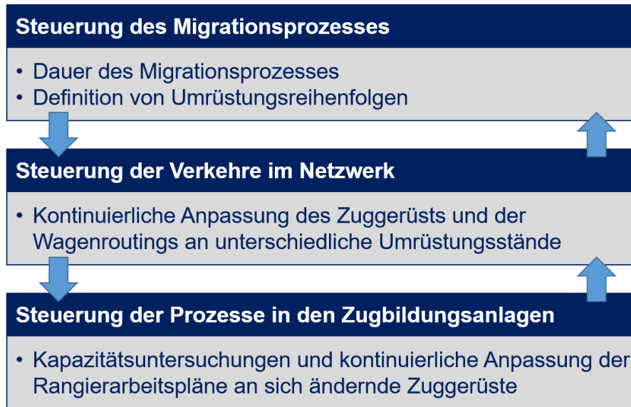
Abbildung 22: Ebenenmodell für die Steuerung einer Migration
