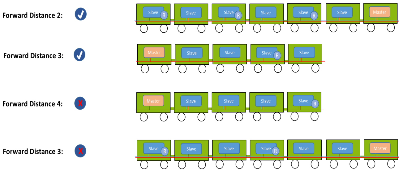
Abbildung 12: Test der Powerline-PLUS Forward Distance in einer Wagengruppe
