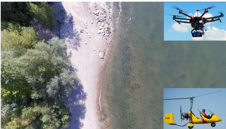
Foto: Drohnen und Gyrocopter ermöglichen dank ihrer höchstauflösenden Sensorik neue Perspektiven für das Monitoring von Strukturen und Vegetation an Wasserstraßen (Quellen: Uferabschnitt: BfG, Drohne: GEOCOPTIX, Gyrocopter: B. Baschek).
