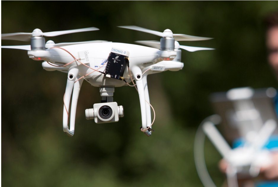
Bild 1: Drohne mit Hook-on-Device für das UTM-System der DFS (© Deutsche Flugsicherung GmbH)
